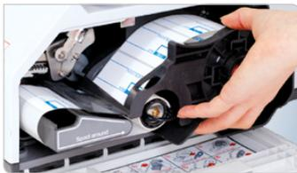
Mit dem CAS Wechsel-Kartuschen-System können die Etikettenrollen komfortabel ausgetauscht werden
