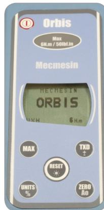
Um das Gerät einzuschalten, drücken Sie die rote Taste
