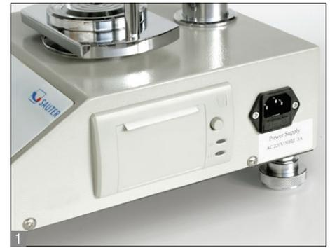
Manueller Prüfstand zur Zug- und Druckprüfung von Federn, mittlere Bauform von 50 N bis 500 N
