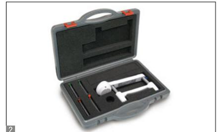
Handkraftmessgerät, z. B. für Rehabilitations-Behandlungen nach Unfällen
