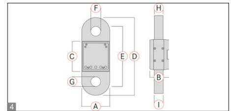
Kompakte Kranwaage mit integrierter Anzeige, auch für Zugkraft messungen verwendbar
