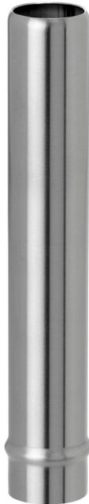
Das Standrohr verschließt zuverlässig das Abflussventil von Spülbecken. Bei Becken mit einer Tiefe ab 250 mm dient es außerdem als Überlaufschutz, indem es überschüssiges Wasser durch das Ventil ableitet.
